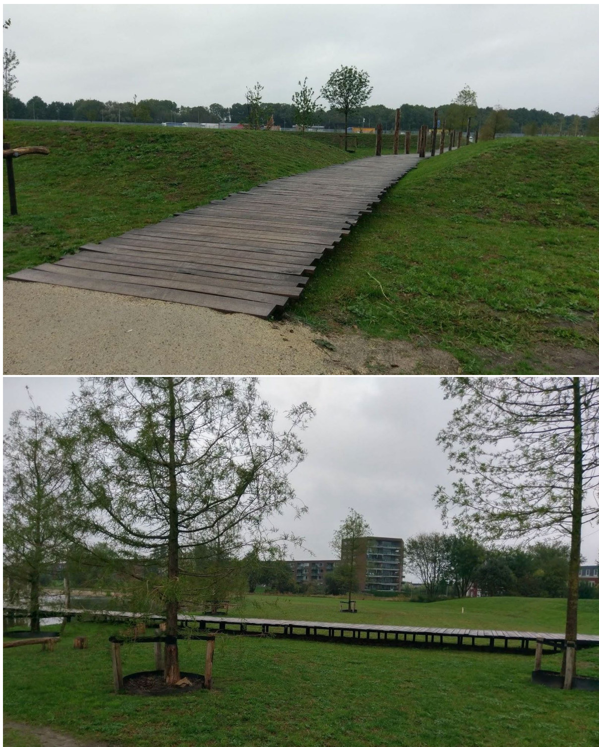
Fig. 5.5.13 - Imagini de ansamblu cu circulațiile principale din zona centrală a Crescentpark, realizate din lemn, în care se poate observa modul în care acestea sunt realizate; pe anumite zone, suspendarea acestor suprafețe de călcare față de nivelul solului permite folosirea structurilor de lemn ca dispozitive de ședere de scurtă durată pentru utilizatorii parcului precum și circulația elementelor de faună
